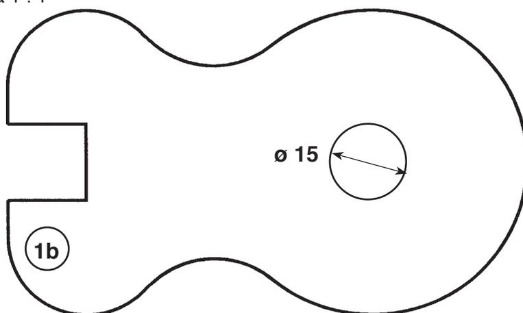
Perforación con una profundidad de 6 mm (Para una variante simplificada, no es necesaria la perforación, pegar directamente el imán en el lugar indicado).
